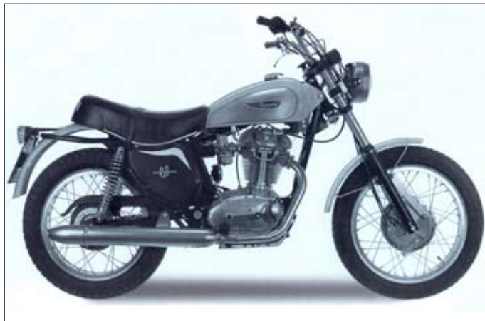
V roce 1973 přišel scrambler o své typické podsedlové brašny. Místo nich dostal pouze krycí panely
