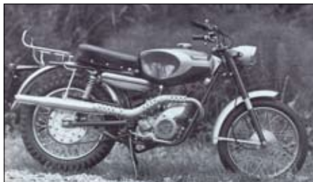
Trialové provedení dvoutaktní padesátky z roku 1964 s chlazením ventilátorem
